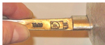
Degenklinge der Marke „BF“ mit FIE-Prüfstempel und Schmiedezeichen (geschmiedet im Dezember 2009)
